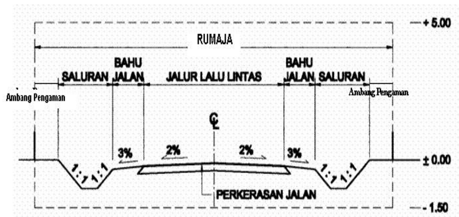
Gambar 3.1 Potongan Melintang Jalan Untuk Jalan Perkotaan
