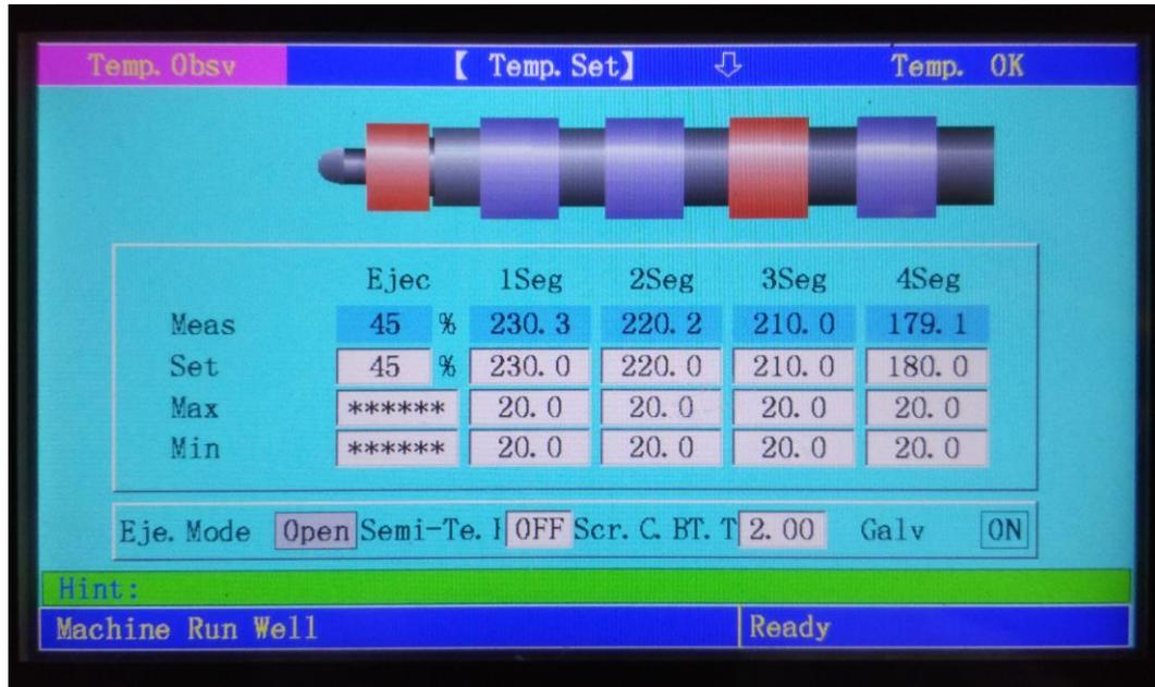
**Gambar 3.17** Parameter temperatur *barrel*
