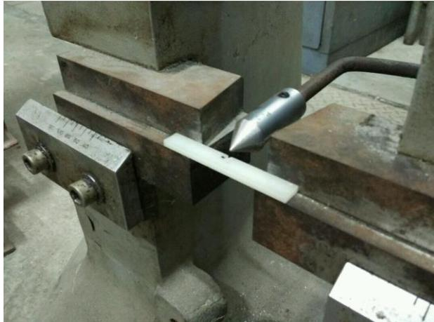
**Gambar 3.21** Posisi spesimen uji impak.
