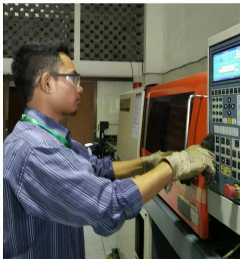
**Gambar 3.12** Memastikan panel injeksi hidup untuk *input* data.
