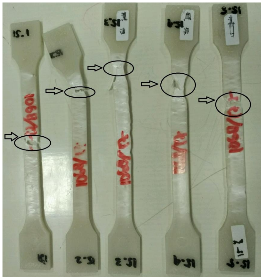
Gambar 4.5 Patahan spesimen multipurpose dengan kandungan filler \text{CaCO}_3 15%.
