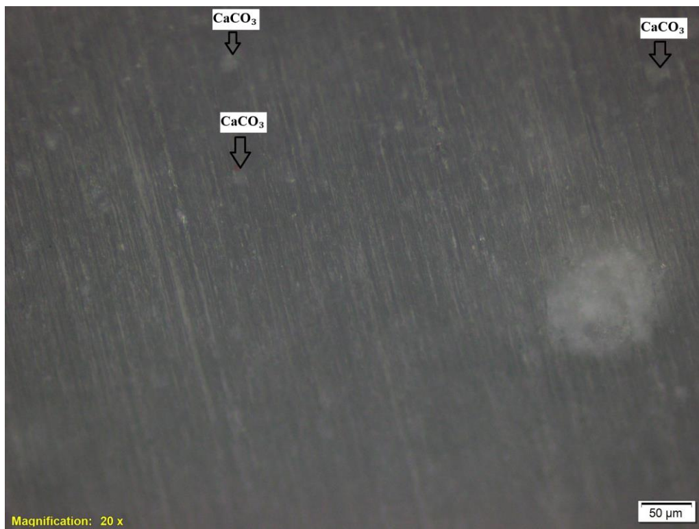
Gambar 4.8 Foto optik patahan spesimen uji kuat tarik dengan kandungan \text{CaCO}_3 15%.
