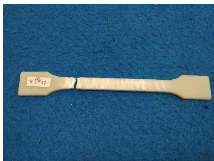
Gambar 3.3 Hasil uji kuat tarik spesimen multipurpose material polypropylene dengan kandungan filler \text{CaCO}_3 15%.
