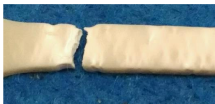
Gambar3.4 Necking dipatahan spesimen.
