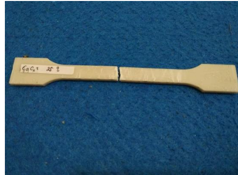
Gambar 3.5 Hasil uji kuat tarik spesimen multipurpose material polypropylene dengan kandungan filler \text{CaCO}_3 25%.
