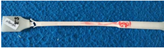
Gambar 4.2 Hasil uji kuat tarik spesimen multipurpose material polypropylene dengan kandungan filler \text{CaCO}_3 5%
