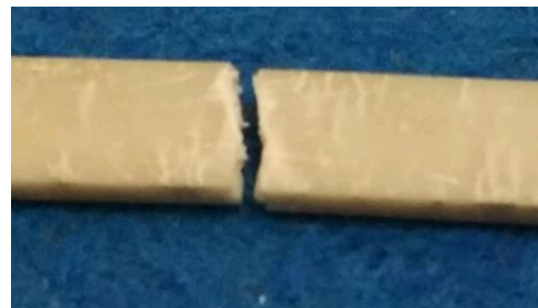
Gambar 3.6 Pola patah getas di spesimen multipurpose dengan kandungan filler 25%.
