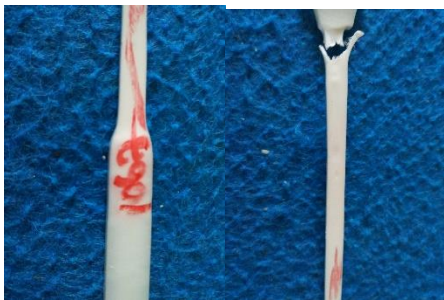
Gambar 3.2 Necking dipatahan spesimen
