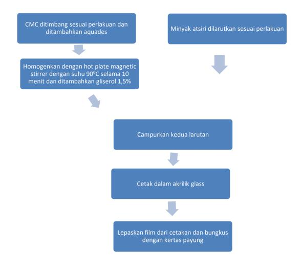
Gambar 2. Alur pembuatan edible film
