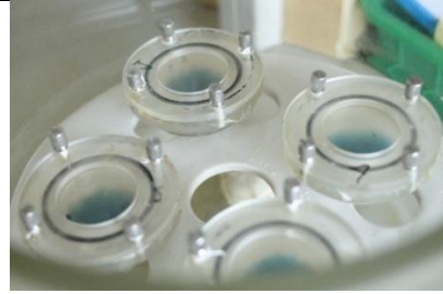
Pengujian WVTR dengan metode cawan
