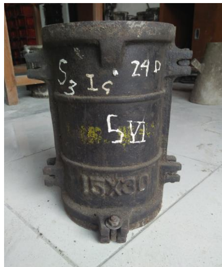
Gambar 4.5 Silinder cetakan beton
