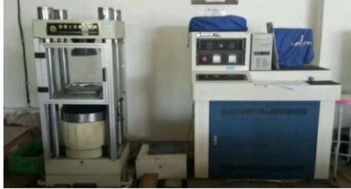
Gambar 4.17 Pengujian kuat tekan silinder beton
