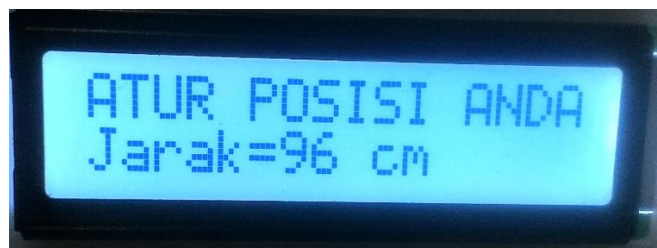
Gambar 4.2 Tampilan LCD setelah mendeteksi objek
