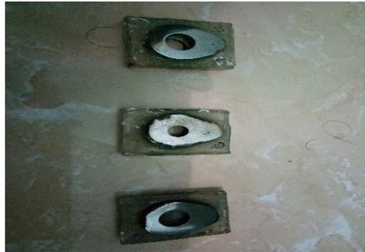
Gambar 3.14 Camshaft yang sudah di resin
