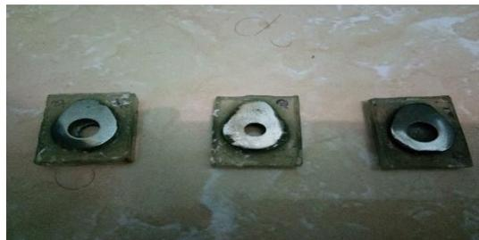
Gambar 3.10 Camshaft yang telah diresin dan dipotong
