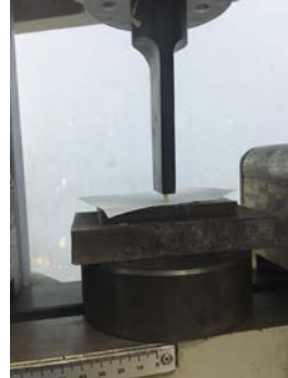
Gambar 11. Pengukuran Kekuatan Tekan
