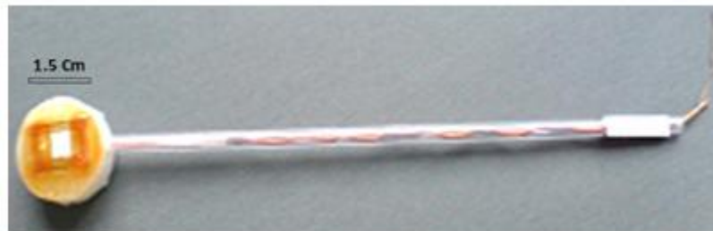
Gambar 2.8 Elektroda yang digunakan selama pengujian korosi. (Sumber: Hashemi et al , 2011)
