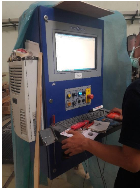
Gambar 4. Proses Persiapan Pemotongan Plat SS AISI 316L ke Bentuk Bundar Menggunakan Waterjet Cutting
