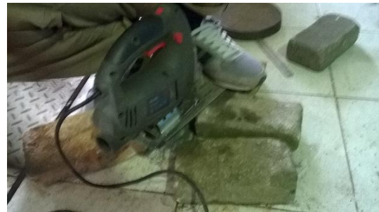
Gambar 1. Proses Pemotongan Plat SS AISI 316L Menggunakan Jigsaw
