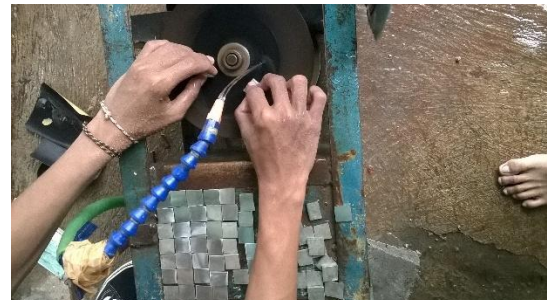
Gambar 3. Proses Pengamplasan Plat SS AISI 316L Menggunakan Mesin Amplas
