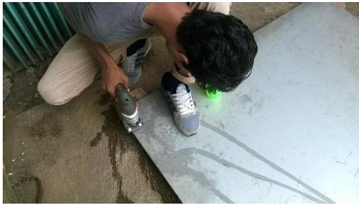
Gambar 1. Proses Pemotongan Plat SS AISI 316L Menggunakan Jigsaw
