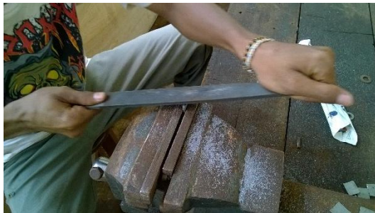
Gambar 2. Proses Pengikiran Plat SS AISI 316L Menggunakan Kikir
