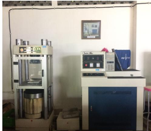
Gambar 4.8 Mesin uji tekan beton
