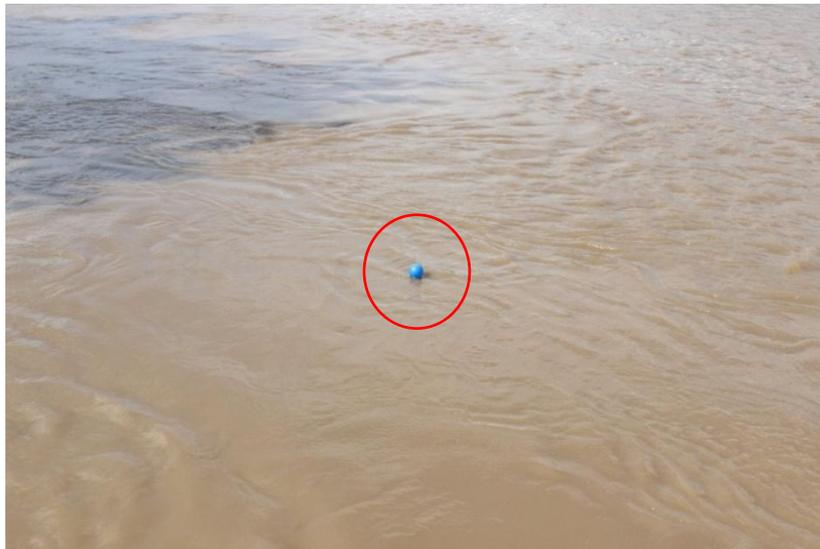
Gambar 4. 8 Pengukuran Kecepatan Aliran Sungai.
