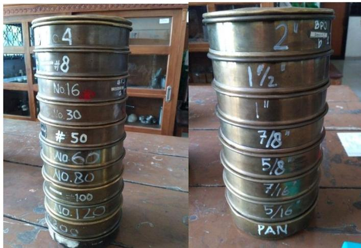
Gambar 4. 40 Saringan yang digunakan saat pengujian Gradasi
