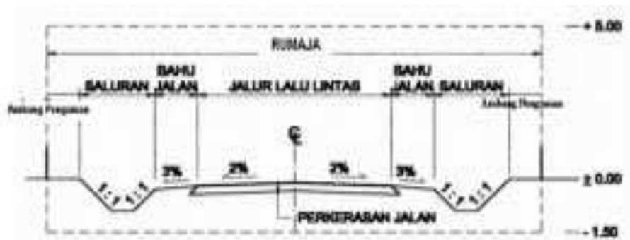
Gambar 3.1 Potongan Melintang Jalan Untuk Jalan Perkotaan
