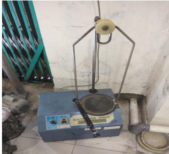
Gambar 4.5 Mesin ayakan ( shaker )
