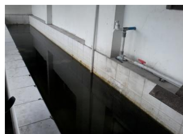
(d) Perendaman beton dalam bak perendaman
