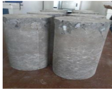
(d) Beton setelah uji tekan
