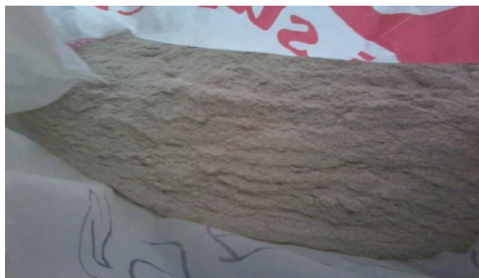
Gambar 4.20 Limbah gypsum yang lolos saringan No. 100 atau setara dengan semen
