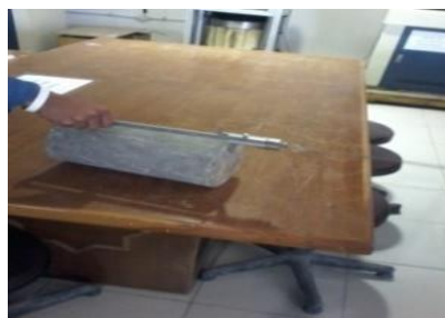
(a) Mengukur dimensi beton
