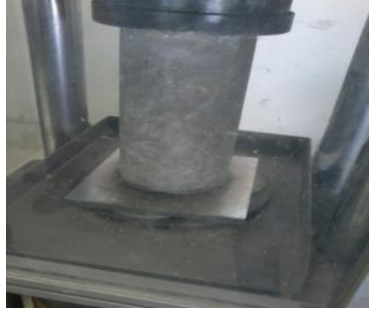
(c) Menguji kuat tekan beton
