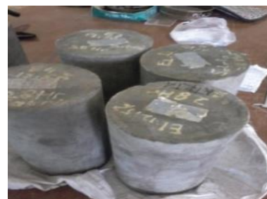
(b) Beton telah siap diuji tekan
