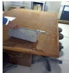
(b) Mengukur dimensi beton
