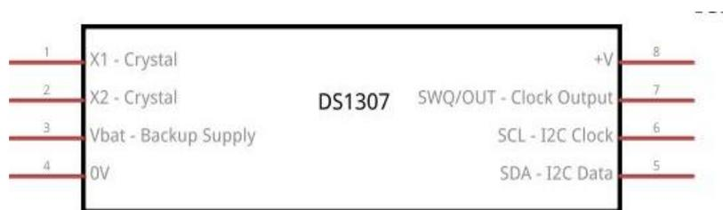
Gambar 2.5 Pin Konfigurasi Real Time Clock DS1307 [9]
