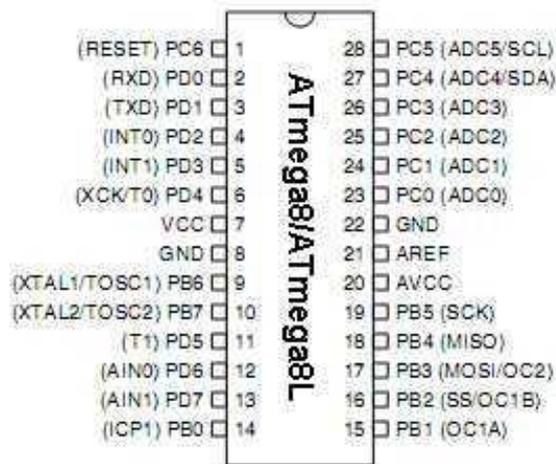
Gambar 2.6 Diskripsi PIN ATmega8
