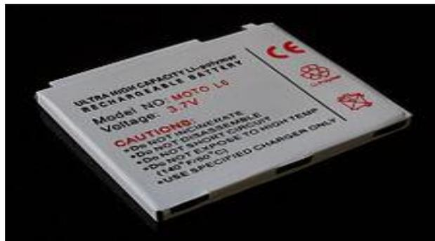
Gambar 2.2 Baterai Lithium Ion bentuk kotak [6]
