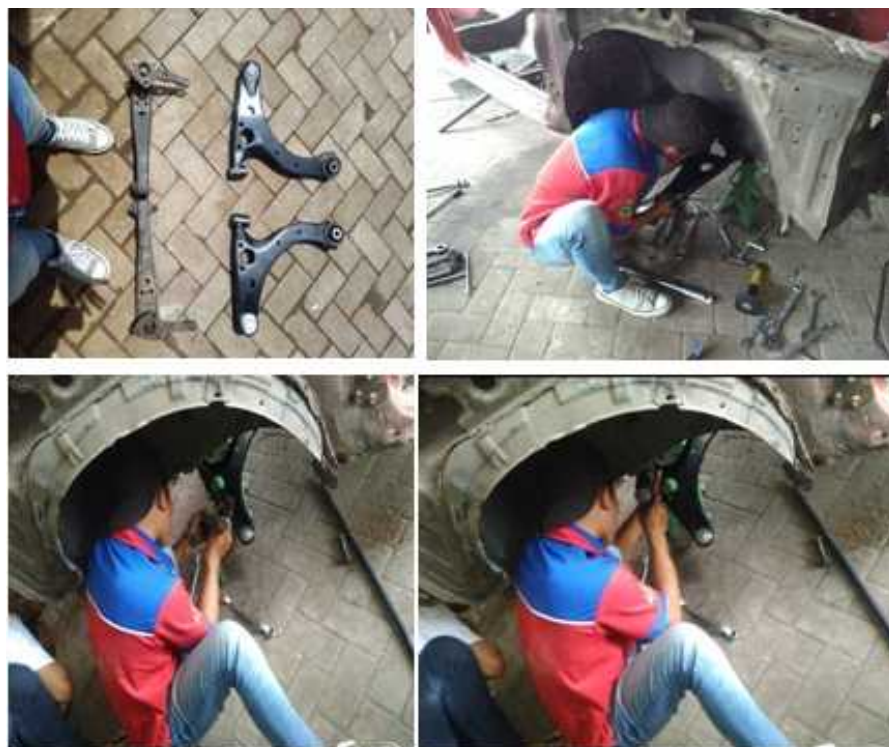
Gambar 4.16 Pemasangan Lower arm custom
