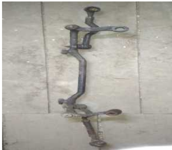
Gambar 4.12 Sistem kemudi tipe reckulating ball
