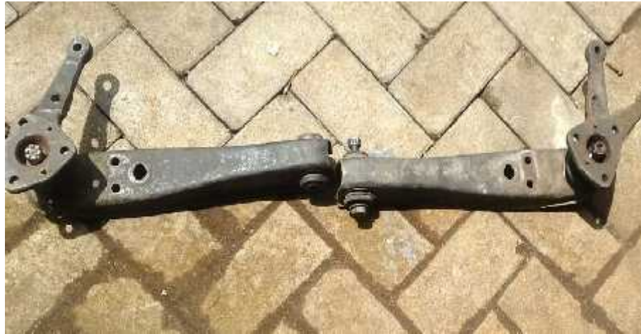
Gambar 4.9 Pemindahan kedudukan tie rod
