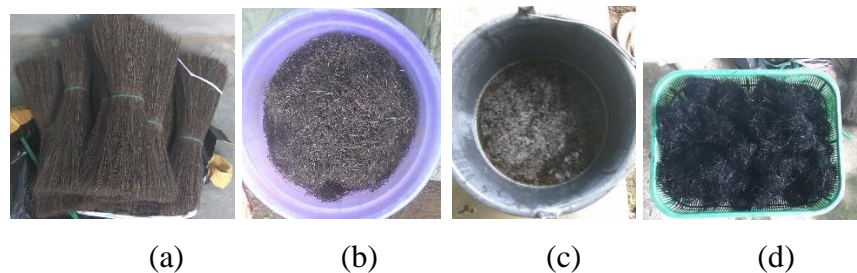
Gambar 3.15. (a) Pemilihan ijuk; (b) Pemotongan ijuk; (c) Proses pencucian ijuk; (d) Pengeringan ijuk
