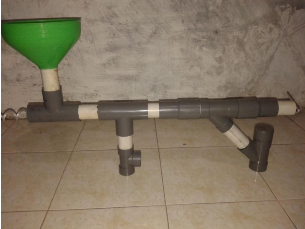
Gambar 3.17 Prototype tempat pakan ayam otomatis
