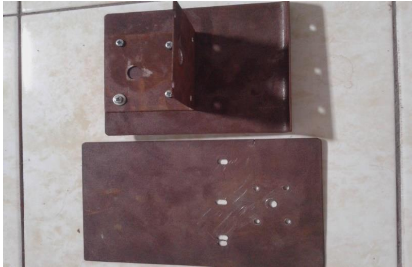
Gambar 3.18 Plat Besi Untuk Kedudukan Motor DC
