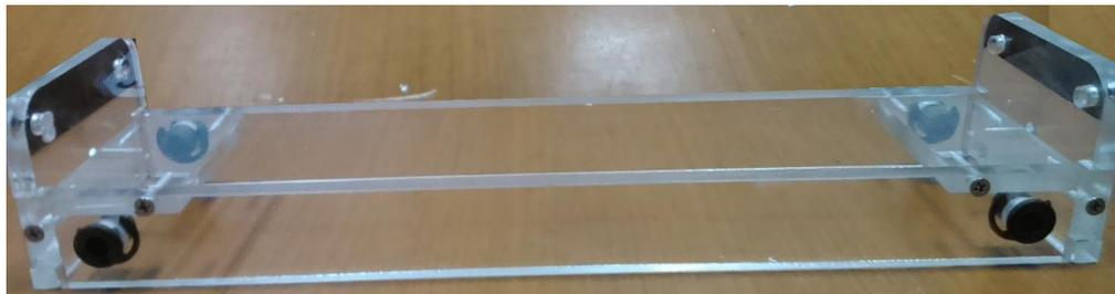
Gambar 4.11 Rangka sumbu X
