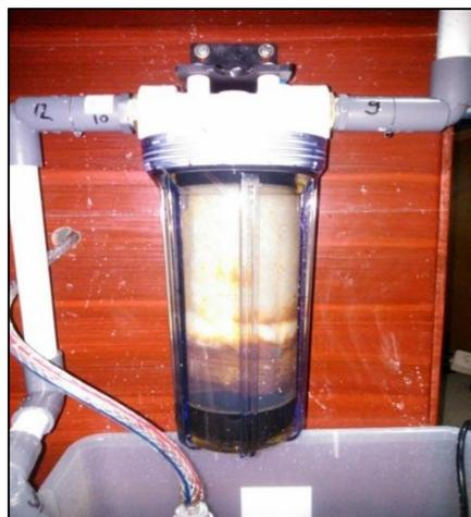
Gambar 4.36 Filter Elektrolit
