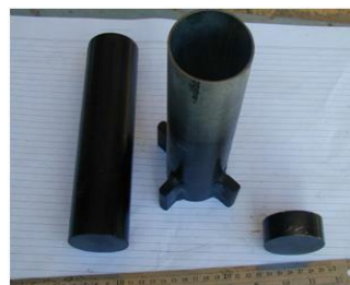
Gambar 5. Cetakan geram besi ( Fe_2O_3 )
