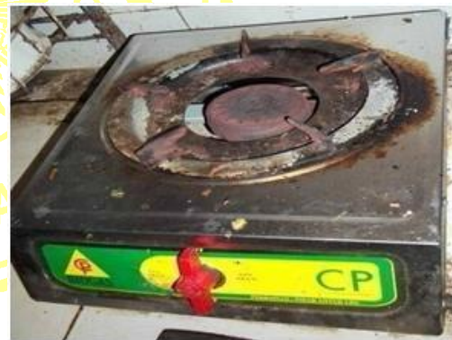
Gambar 2. Kasus korosi parah yang terjadi pada kompor dengan menggunakan bahan bakar biogas karena kandungan gas H_2S yang tinggi
