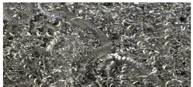
Gambar 3. Gram besi limbah dari proses pembubutan. Limbah ini sangat potensial untuk diolah menjadi alat untuk memurnikan bioas dari gas pengotor H_2S
