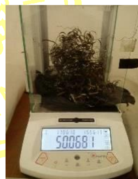
Gambar 4. Proses penimbangan berat pada geram besi ( Fe_2O_3 )
