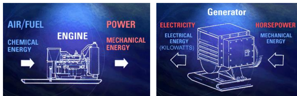
Gambar 2.11. Konversi energi kimia ke mekanik lalu menjadi listrik
