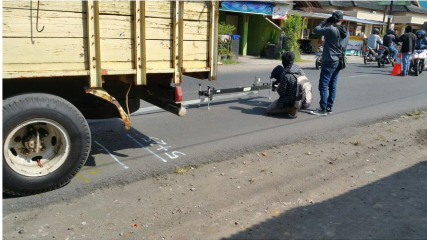
Pengaturan kaki kaki BB agar alat menjadi seimbang serta pengaturan arloji pengukur lendutannya
