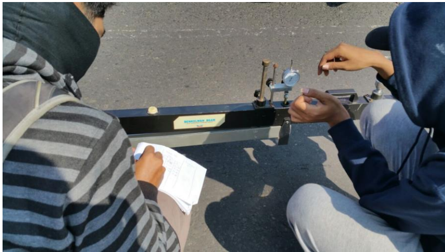
Pembacaan lendutan yang terjadi saat truk berjalan dari titik d1 ke d2 dan ke d3
