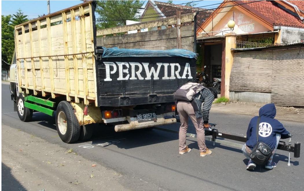
Gambar 4.2 Truk Alat Uji Pembebanan pada lokasi penelitian
