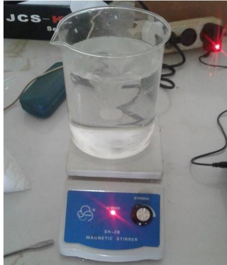
Gambar 3.7. Pencampuran NaCl dan Aquades menggunakan *magnetic stirrer*
