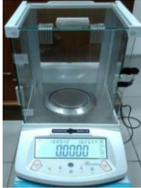
Gambar 3.12. Pengukuran massa menggunakan timbangan digital
