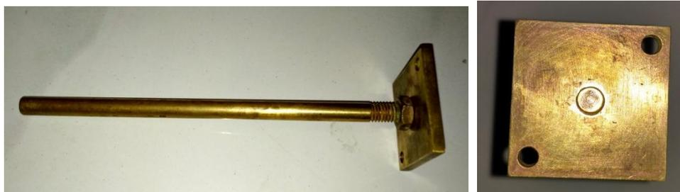
Gambar 3.3. *Toolelektrode* tidak berpola
