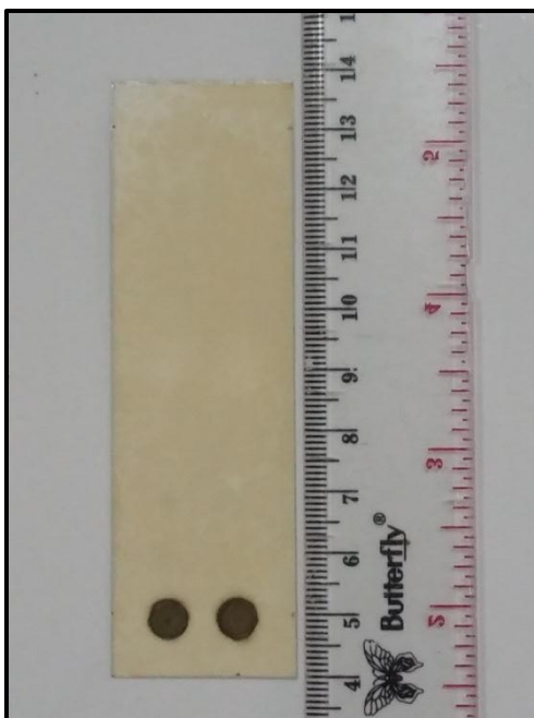
Gambar 11. Hasil uji KLT senyawa Tanin dengan penyemprotan \text{FeCl}_3 di bawah sinar tampak
