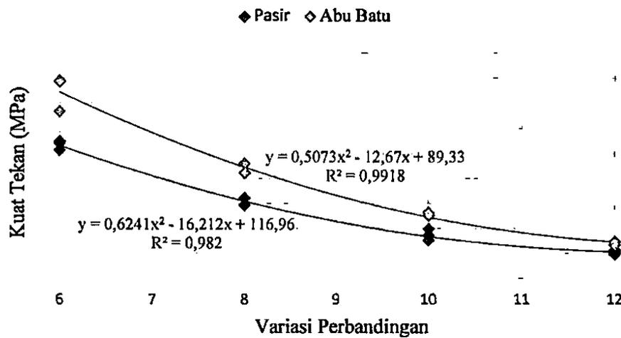
Gambar 1.1 Hubungan variasi pasir dan abu batu 1:6, 1:8, 1:10, 1:12.
