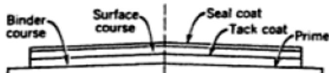
Gambar 2.2 Sub-lapisan permukaan perkerasan lentur
