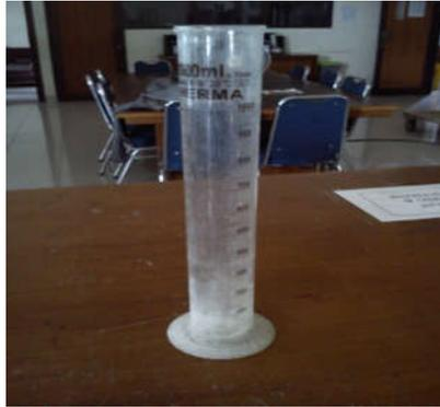
Gambar 4.6 Gelas ukur kapasitas 1000 ml
