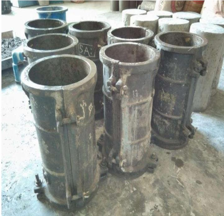
Gambar 4.15 Cetakan silinder beton
