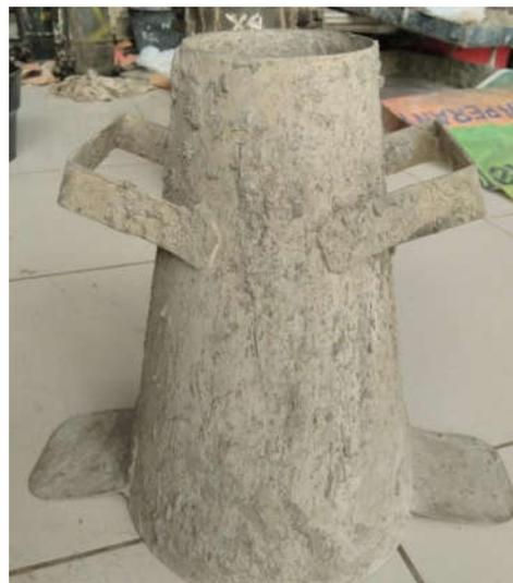
Gambar 4.14 Kerucut *Abrams*
