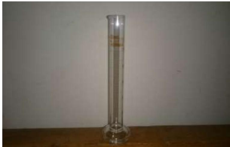
Gambar 3.10 Gelas Ukur Kapasitas (50 ml)
