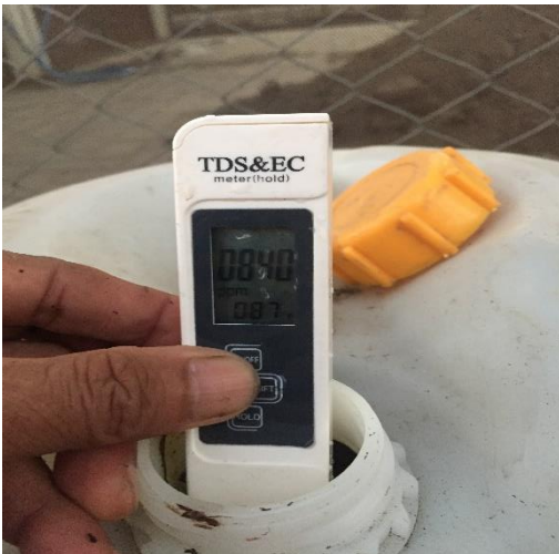
Pengukuran dengan menggunakan EC meter
