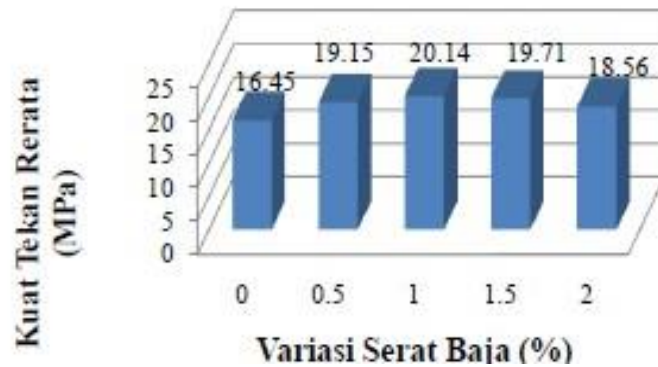
Gambar 2.3 Kuat tekan dengan variasi serat baja dan serat Polypropylene (Ramarhiska, 2012)
