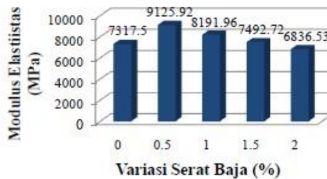
Gambar 2.4 Grafik modulus elastisitas rata-rata variasi serat baja dan serat polypropylene (Ramarhiska, 2012).
