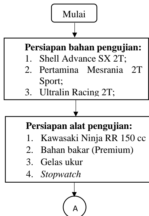
Gambar 3.3 Diagram alir pengujian konsumsi bahan bakar
