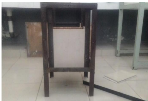
Gambar 3.3. Tungku uji pembakaran
