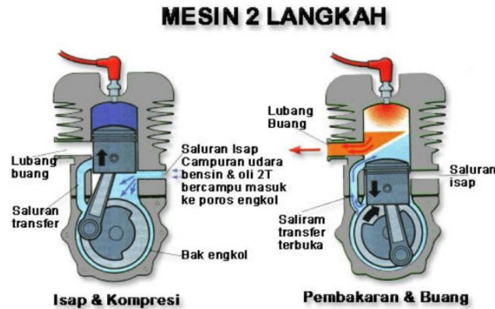
Gambar 2.7 Siklus kerja engine 2 tak/2 langkah (Fauzien, 2008)
