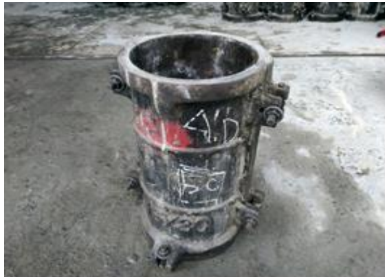
Gambar 4.6 Silinder cetakan beton
