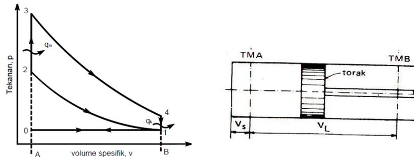
Gambar 2.1. Diagram P dan v dari siklus volume konstan (Sumber : Arismunandar, 2002)
