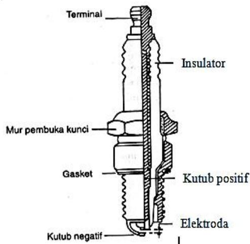
Gambar 2.18 Konstruksi Busi (Bagas, 2010)
