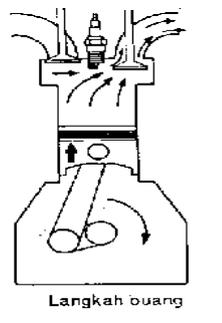
Gambar 2.5 Prinsip kerja langkah Buang (Suyanto, 2000)
