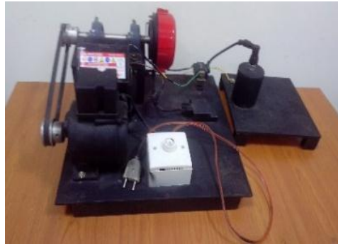
Gambar 3.12 Alat Uji Pengapian Busi
