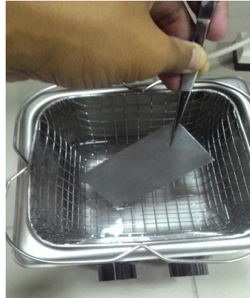
Gambar 1.14 Pengangkatan material setelah dilakukan pembersihan
