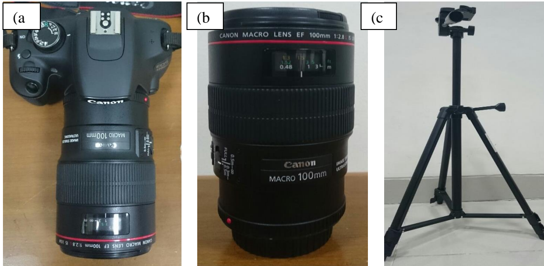
Gambar 1.3 (a) Kamera canon DSLR seri 1200D (b) Lensa kamera canon makro dengan ukuran 100mm (c) Tripod kamera DSLR
