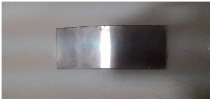
Gambar 1.4 Alumunium dengan ketebalan 1mm
