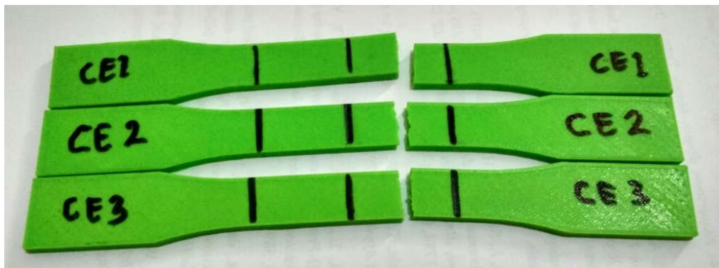
Gambar 4.17. Spesimen eksperimen konfirmasi setelah pengujian tarik
