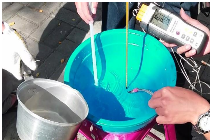
Gambar 4.1 kegiatan kalibrasi thermocouple
