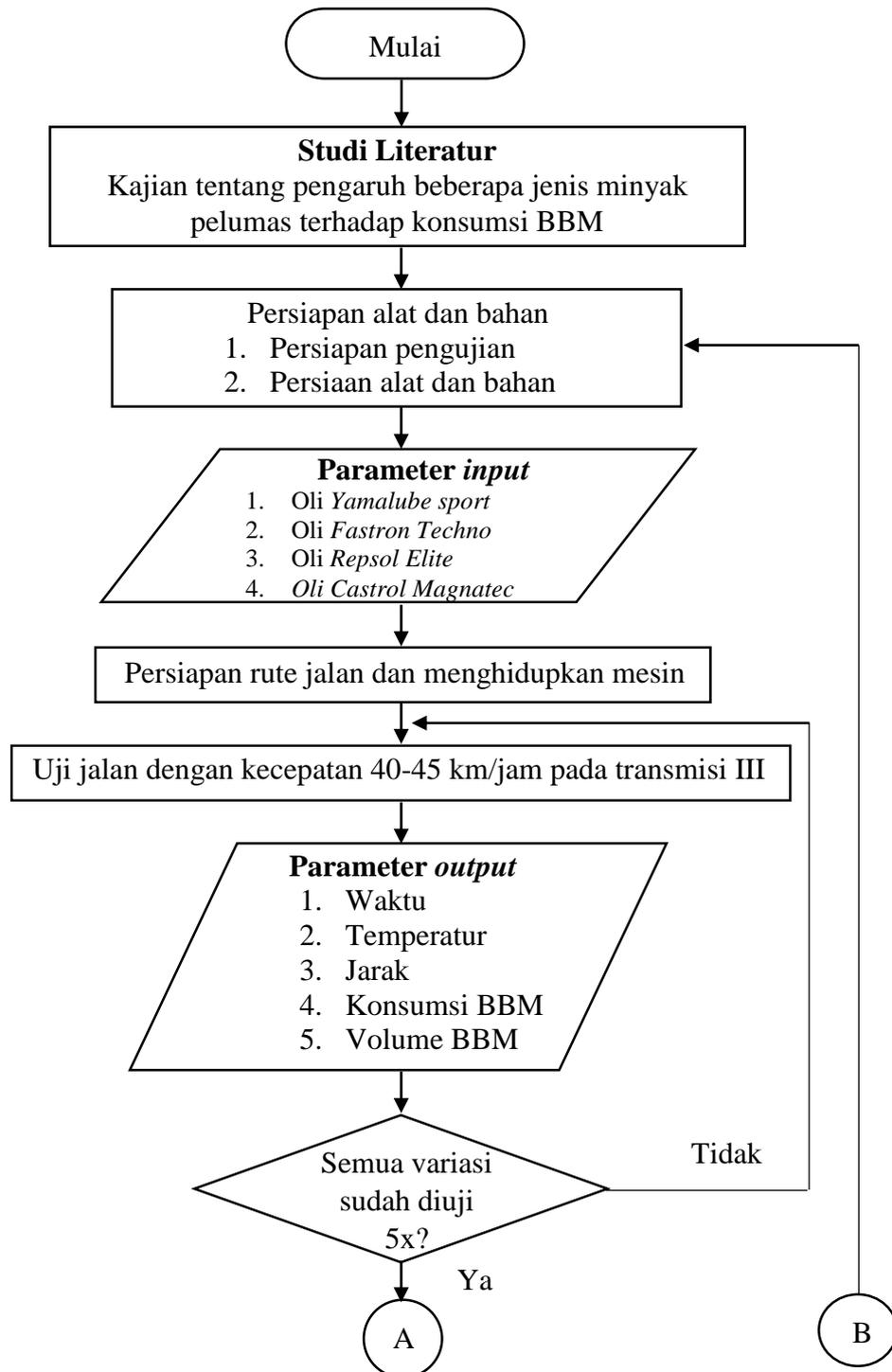
**Gambar 3.30.** Diagram alir pengujian konsumsi bahan bakar
