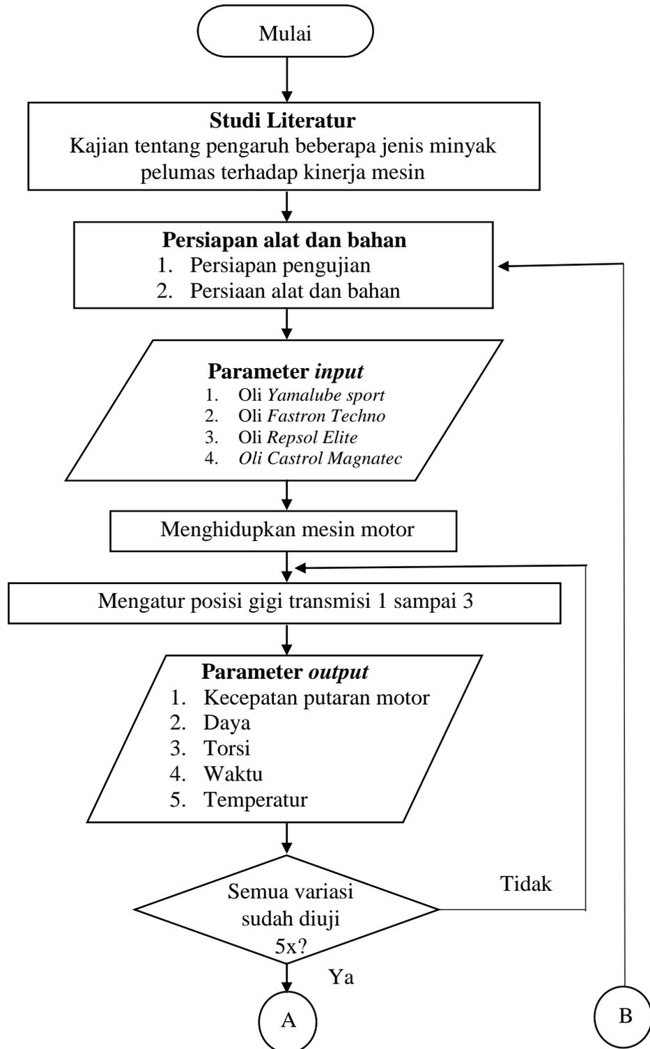
**Gambar 3.25.** Diagram alir pengujian daya dan torsi.
