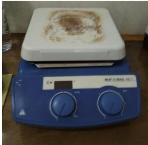
**Gambar 3.22.** *Heater* pemanas minyak pelumas
