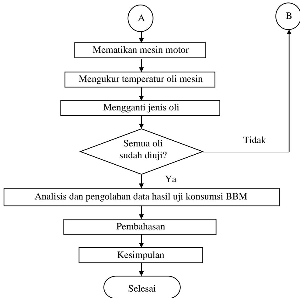
**Gambar 3.30.** Diagram alir pengujian bahan bakar (lanjutan)
