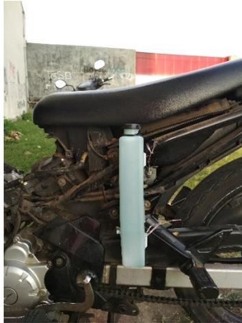
**Gambar 3.32.** Pemasangan tangki mini pada motor
