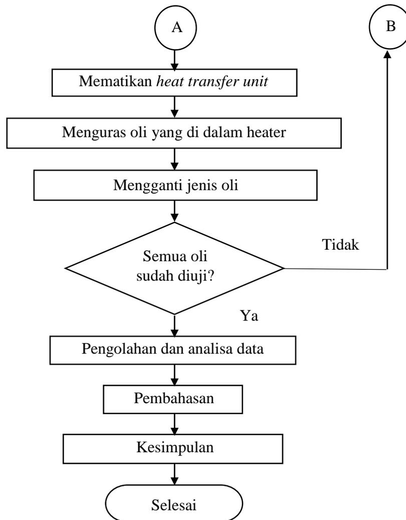
**Gambar 3.3.** Diagram alir pengujian konduktivitas termal (lanjutan)
