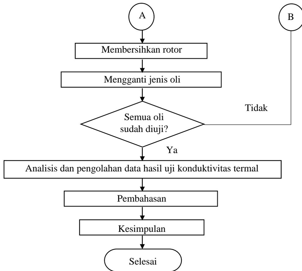
**Gambar 3.15.** Diagram alir pengujian viskositas (lanjutan)
