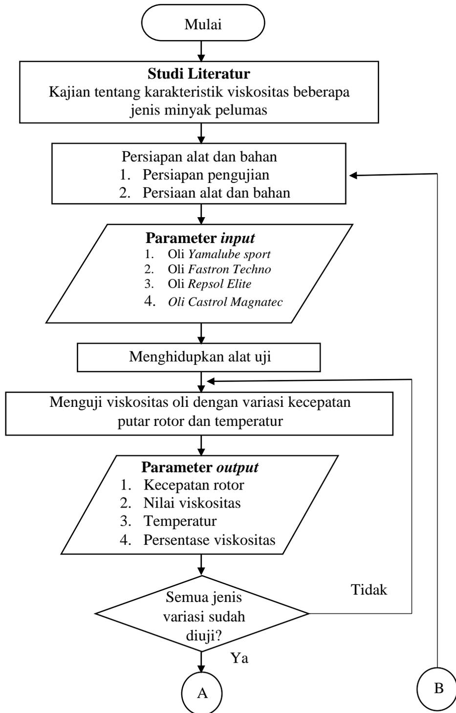
**Gambar 3.15.** Diagram alir pengujian viskositas
