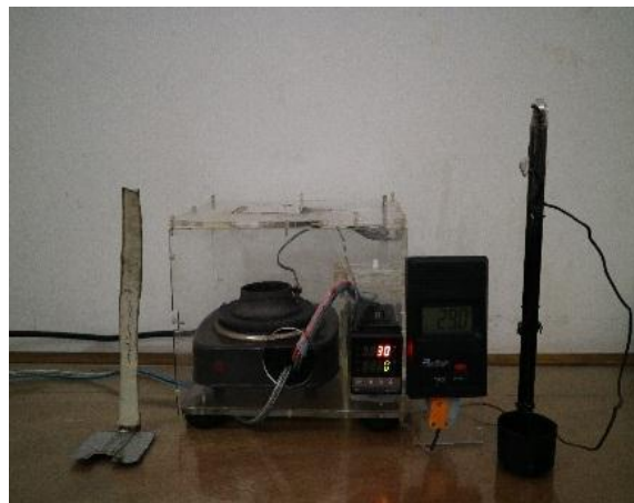
Gambar 3. 12 Alat uji flash point
