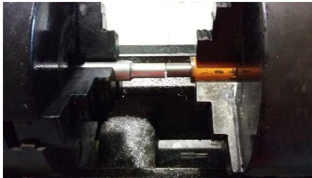
Gambar 3.15 Pemasangan Spesimen pada Posisi Center
