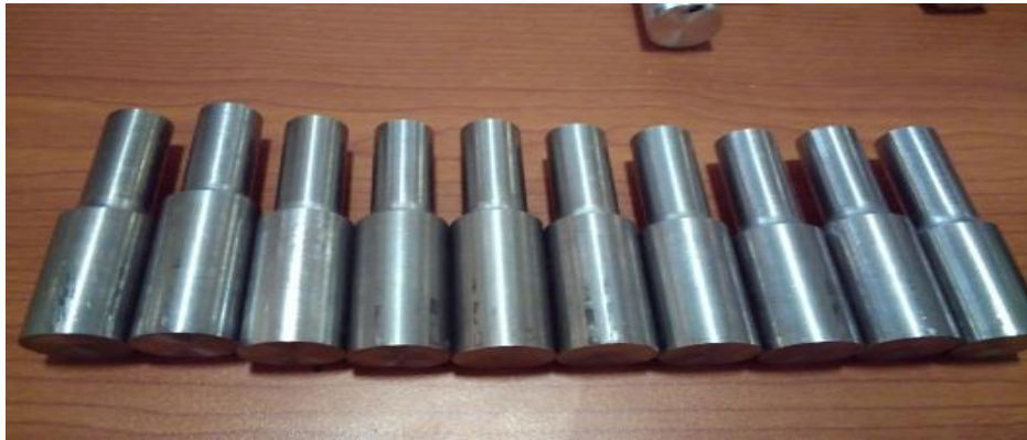
Gambar 3.14 Hasil Pemotongan Bahan Stainless Steel 304 yang sudah dibuat sesuai dengan Standar JIS Z 2201.
