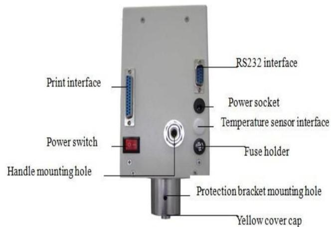
**Gambar 3.16** Bagian kepala *viscometer*
