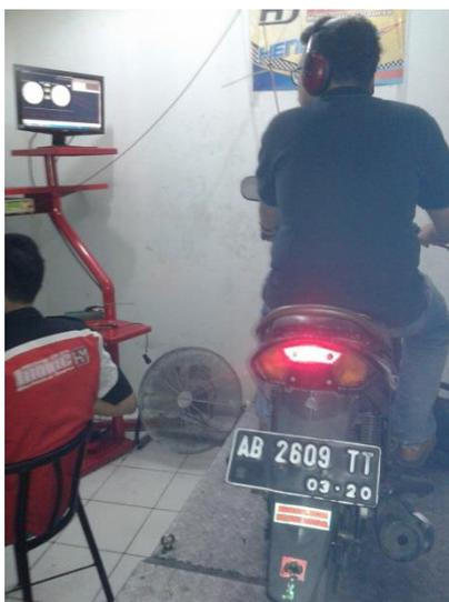
**Gambar 3.54** Posisi pengukuran torsi dan daya
