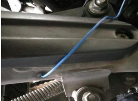
**Gambar 3.42** Sensor pada saluran gas buang (knalpot)
