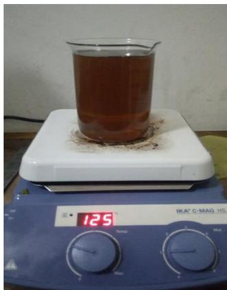
**Gambar 3.19** Hot Plate Stirrer dengan gelas ukur
