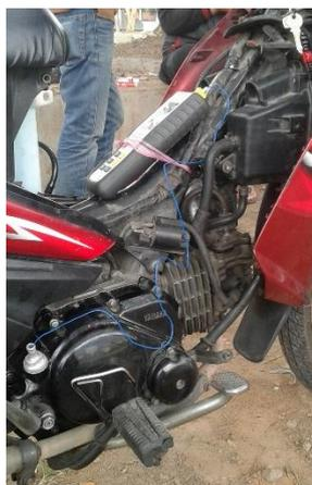
**Gambar 3.63** Posisi *thermocouple reader* selesai pengujian
