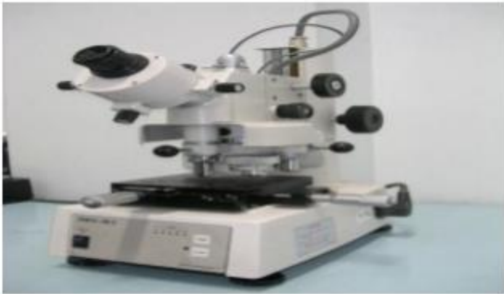
Gambar 3.6 Mesin uji kekerasan micro Vickers (laboratorium D3 Universitas Gajah Mada).
