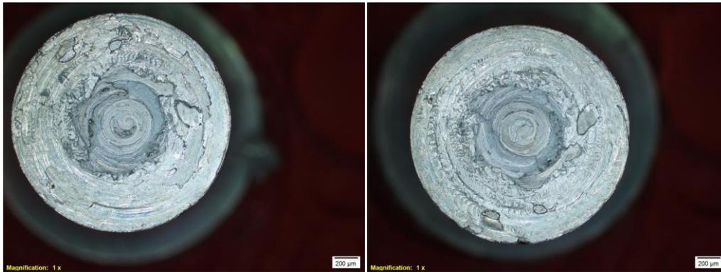
Gambar 4.12 Hasil patahan uji tarik variasi waktu gesek 2 detik.
